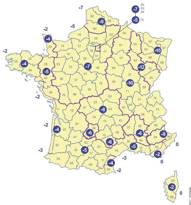
La puissance délivrée par la PAC est fonction de la température extérieure de base (T<sub>base</sub>).
