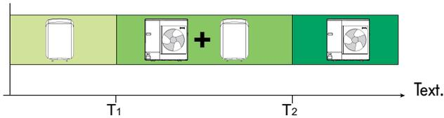
T1 : température extérieure minimale d'arrêt du compresseur de la PAC.
